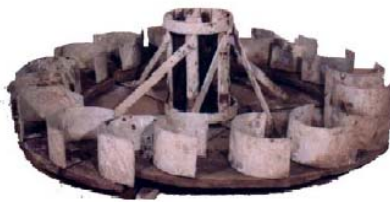
Fig. 1 : Roue à augets tournant avec le poids de l'eau (IIème s. av. JC) ( www.musee-hydrelec.fr )
